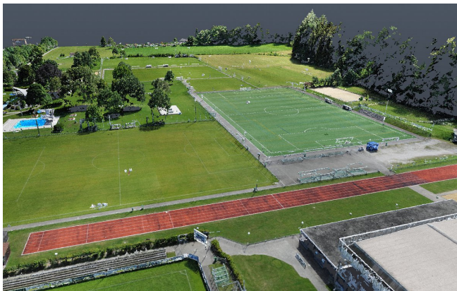
Punktwolke aus der Drohnenbefliegung für die Geländemodell-Erstellung
