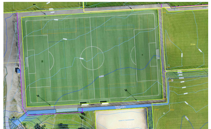
Hochaufgelöstes Orthophoto mit überlagerten Höhenkurven (10cm Äquidistanz)
