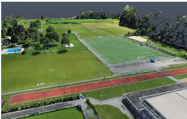
Punktwolke aus der Drohnenbefliegung für die Geländemodell-Erstellung
