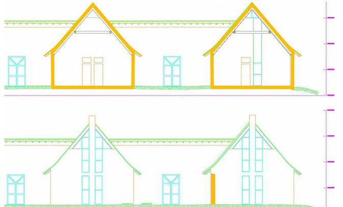
Querschnitt (oben) und Ansicht (unten) der nördl. Zellenhäuschen (CAD-Darstellung)
