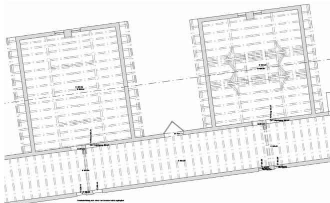
Grundriss EG der Zellenhäuschen mit komplexer Balkenlage (Planansicht)
