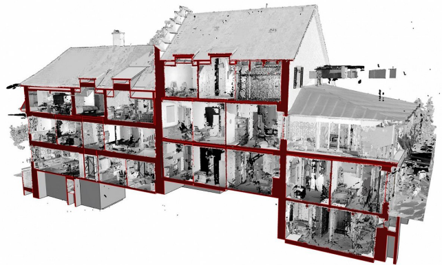
3D-Modell Nebengebäude überlagert mit Punktwolke
