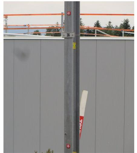
Messpunkte für Gleis- und Mastüberwachung
